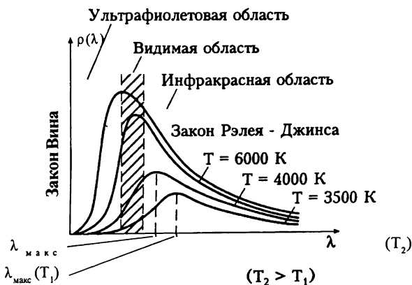
Рис. 17б. Опытные кривые зависимости интенсивности излучения черного тела от длины волны света при различных значениях температуры. Штриховкой обозначена видимая часть спектра излучения.
