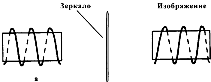
Рис. 35. а) Винт с правой резьбой; б) его зеркальное изображение в виде винта с левой резьбой.
