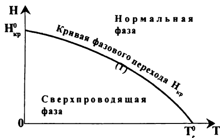
Рис. 71. Кривая фазового перехода из сверхпроводящего состояния в нормальное в зависимости от величины напряженности внешнего магнитного поля.
