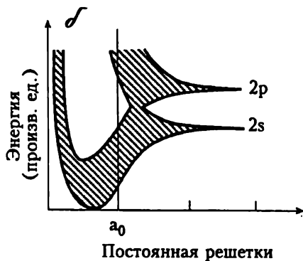
Рис. 63. Расщепление дискретных энергетических уровней в кристаллах в зависимости от расстояния между ближайшими соседними атомами, a_0 – параметр решетки. а) случай кристалла натрия; б) случай кристалла алмаза.
